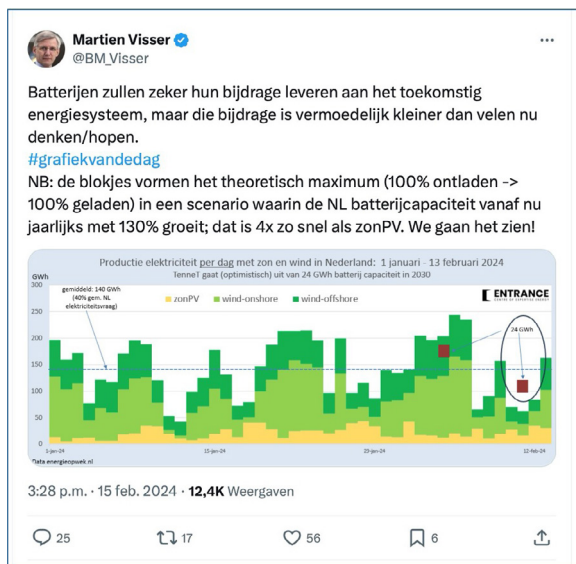
Figuur 2.1: Rol van thuis- en buurtbatterijen in Nederland in 2030 (rode blokjes) geprojecteerd op de huidige elektriciteitsproductie en 130% groei van die batterijen per jaar.
