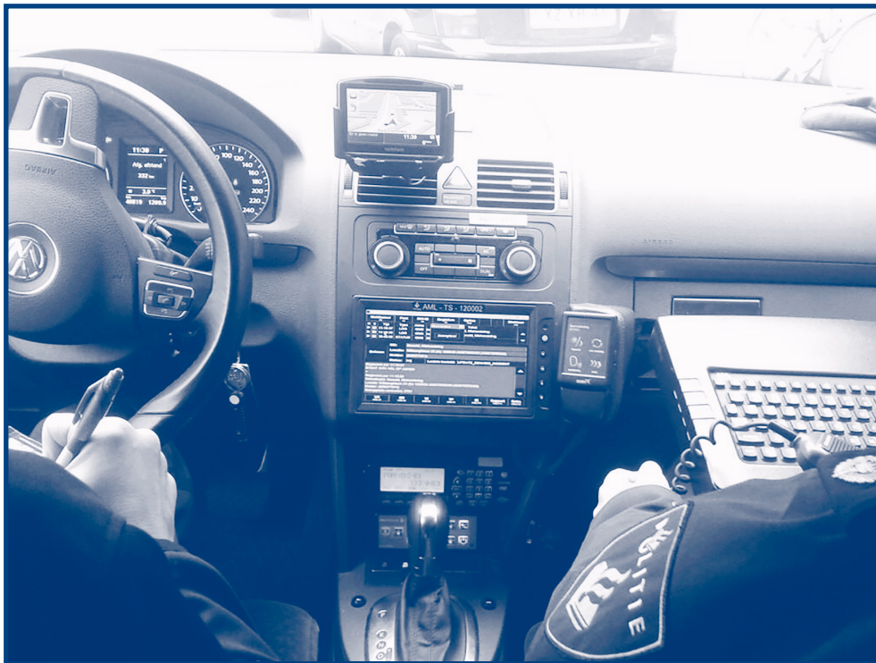
Figuur 4.6: Foto van het MDT-scherm op het dashboard (Bron: Eric Kooijman)
